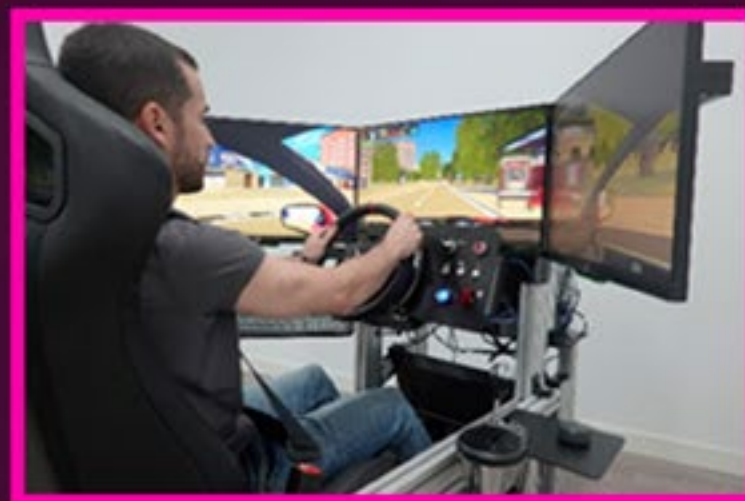
Figura 2 - Simulador de manejo de vehículos Fuente: simumak.com
